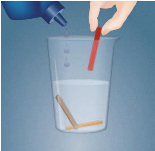
1. Becherglas halb mit Wasser füllen, dazu ein Spritzer Spülmittel. Legt die sechs Proben hinein.
