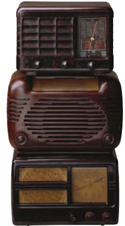
Selbst diese Radiogehäuse wurden bereits aus synthetisiertem Kunststoff hergestellt.
