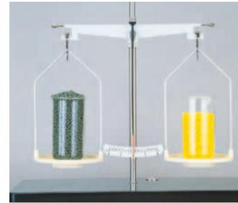
Polyethylen ist etwas leichter als Polyvinylchlorid.
